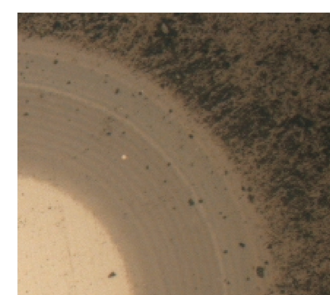
Nanocomposite Triple-Schichten: sehr hohe Verschleißbeständigkeit
