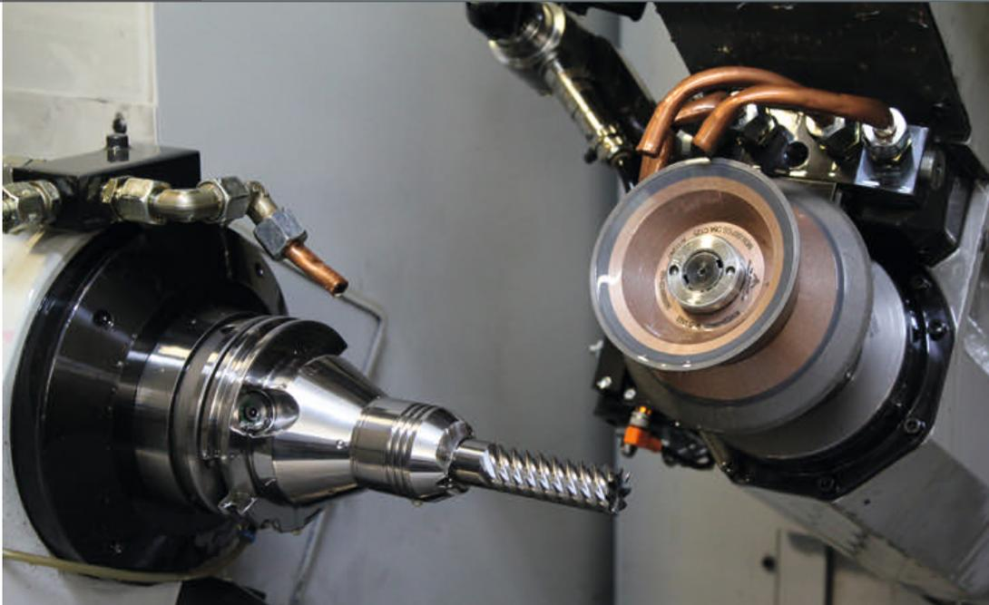
**1** Bei der Werkzeugaufbereitung garantiert der zertifizierte Komet-Service-Partner ein professionelles Vorgehen. Exakt definiert durch einen streng kontrollierten und protokollierten Arbeitsablauf wird der Original-Nachschliff auf Hightech-Maschinen vorgenommen
