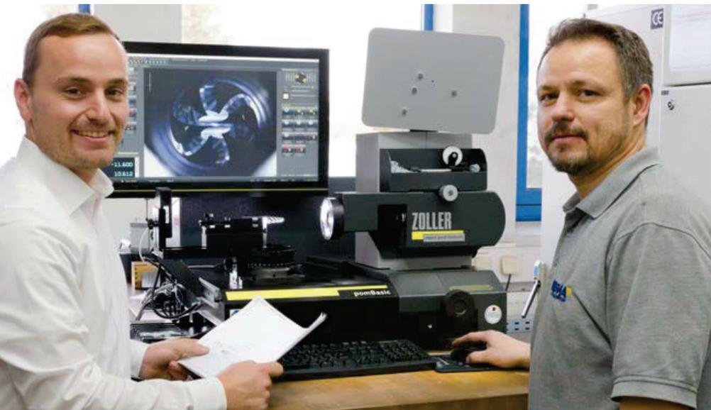
Standard beim Schleifen rotations-symmetrischer Werkzeuge: Florian Prem (l.) und Marcel Bedus (r.) vertrauen beim Messen der Schneidengeometrien geschliffener Zerspanungswerkzeuge auf die bewährte Messtechnologie der Messgeräte »pomBasic« von ZOLLER.
