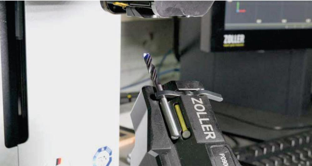
Kleinste Geometrien hochgenau erfassen: Mit Laserlicht erfasst das Messgerät »µFocus« bei 10 x 10 mm messendem Messfleck exakt die Schneidengeometrien auch bei Bohr- und Fräsworkzeugen kleiner Durchmesser.
